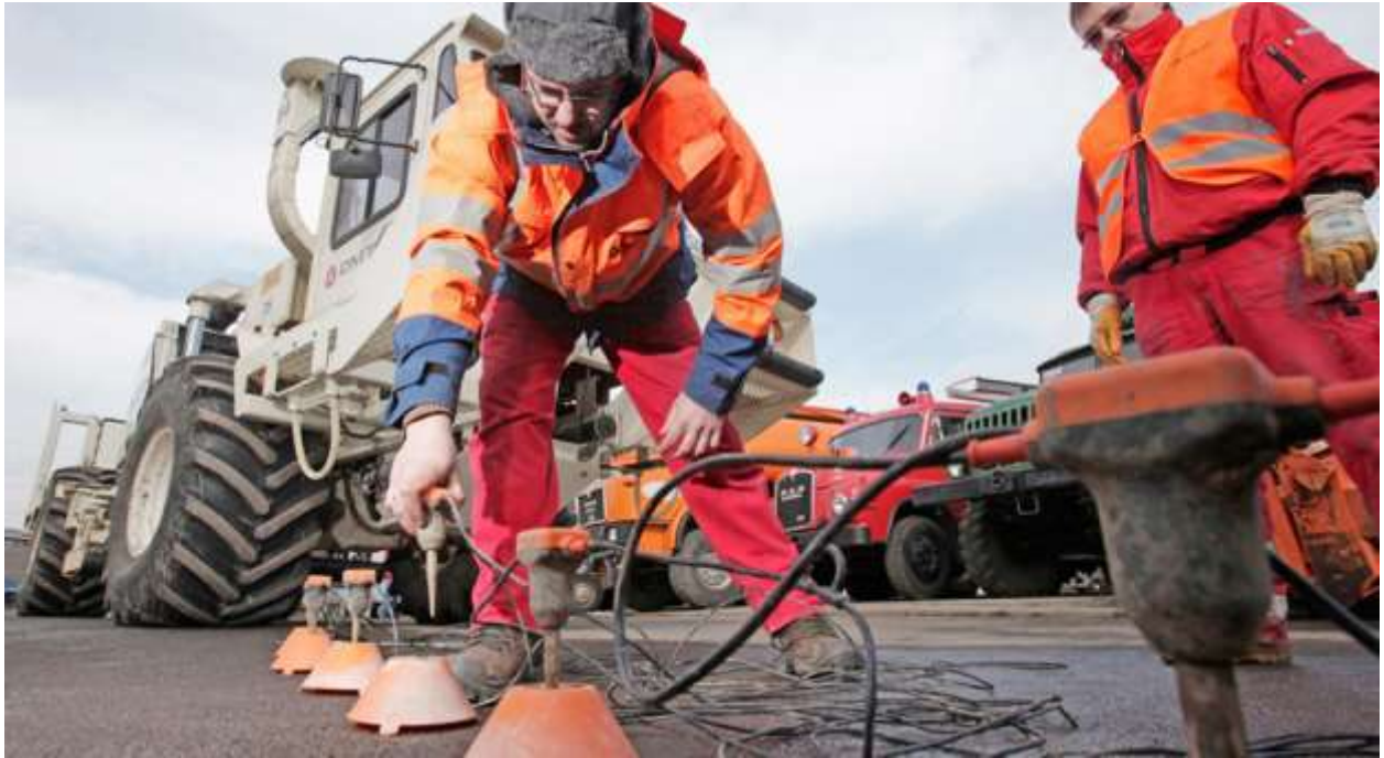
Fotografia 1. Principiul măsurătorilor seismice (1)
